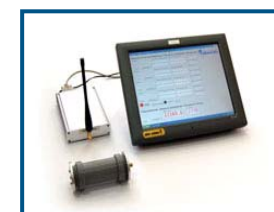
Система контроля напряженно-деформированного состояния зданий и сооружений
